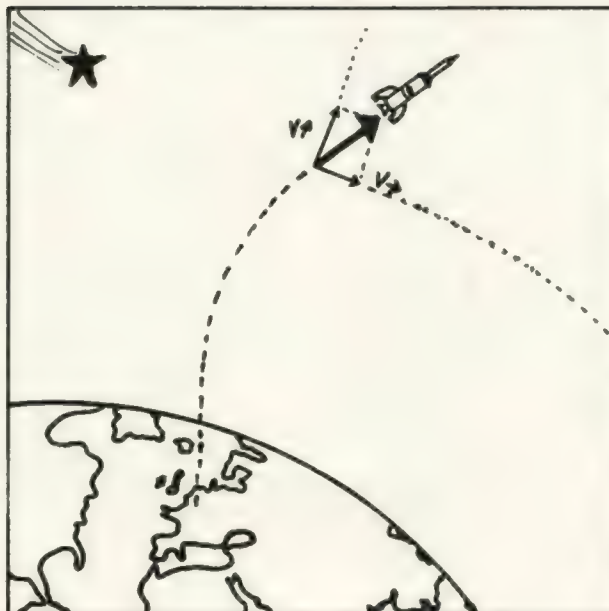
La vitesse réelle de la fusée est décomposée en vitesse verticale V_f et vitesse horizontale V_h parallèle à la surface de la terre.
